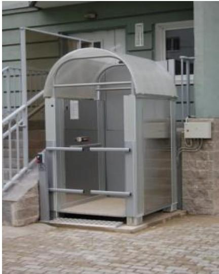
Подъемная платформа БК 450 обеспечивает вертикальное перемещение инвалидов в креслах-колясках и других маломобильных групп населения. Устройство может использоваться как внутри помещения, так и на улице. Поручни на платформе открываются автоматически. Для обеспечения возможности выезда/заезда на платформу устройство оснащено тремя пультами управления: на самой платформе, на стойке верхней и нижней остановки.
